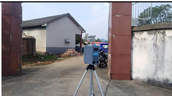
无组织废气采样照片 1
