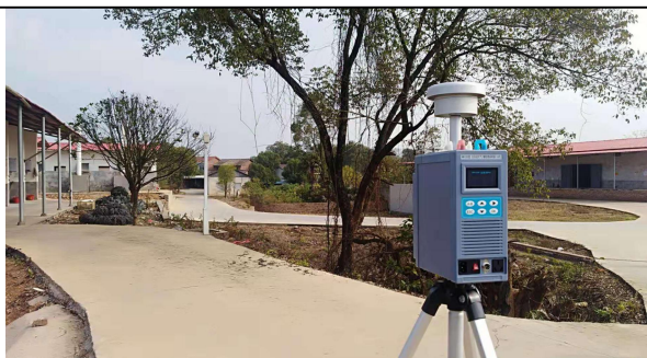
无组织废气采样照片 3
