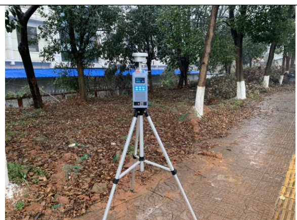
无组织废气采样照片 2
