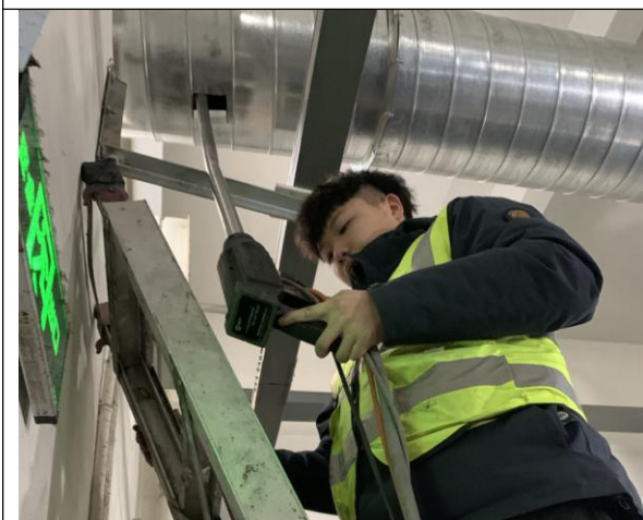
硫化废气进口采样照片 2
