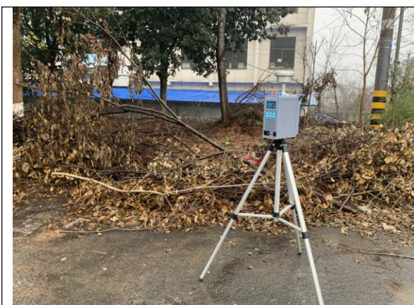
无组织废气采样照片 1
