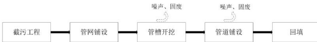
图 4.1-2 截污纳管施工流程图
