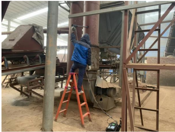
布袋除尘器有组织采样
