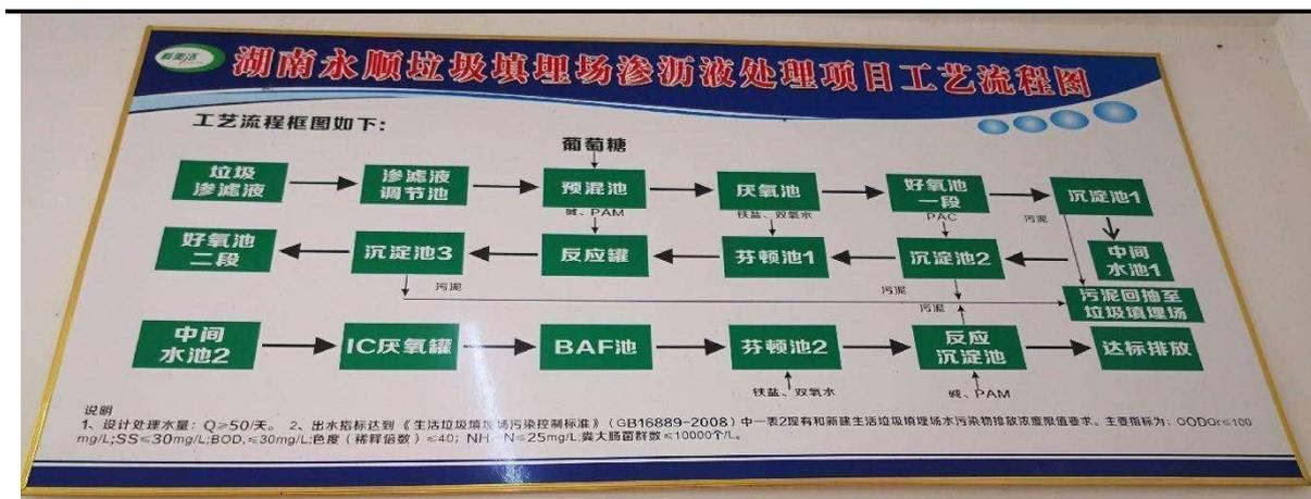
渗滤液处理工艺流程
