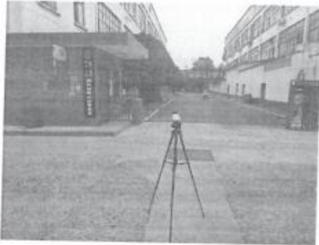
N 3 ▲3#厂界西侧外1m处噪声检测
