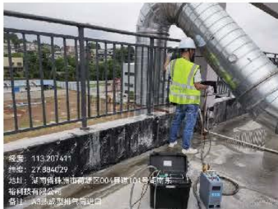
A 3 有组织废气采样照片
